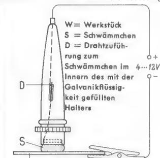
Bild 2. Anschließen des Galvanisiergerätes Chrom-Fix
